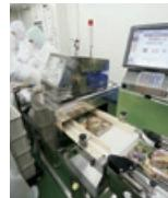
目視による検品に加え、金属探知機でお弁当の中に金属などが入っていないかをよく確認し、製造年月日などが印字されたシールを自動で貼り付けます。
