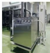
泡状の水でお米を洗浄します。洗浄時の欠けや傷を防ぐことが出来ます。
